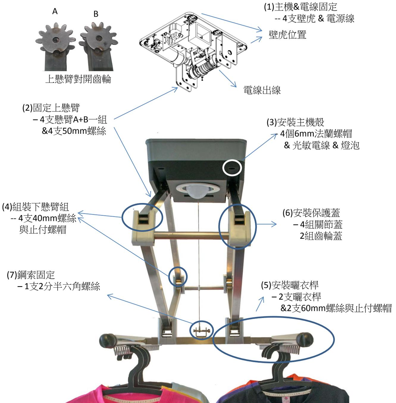
工具：(1)10號套筒1支(2)13號套筒2支(3)固定主機可用2分半壁虎或3分牙條螺帽
